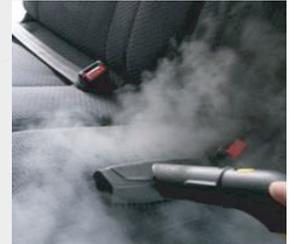
Para el caso de vehículos con tapicería, para garantizar una óptima sanitización y desinfección donde no alcanza a penetrar el desinfectante aplicados con nebulizadores, usamos vaporizadores para que puedan penetrar la cojinería del vehículo. salas de cirugía, entre otros.
